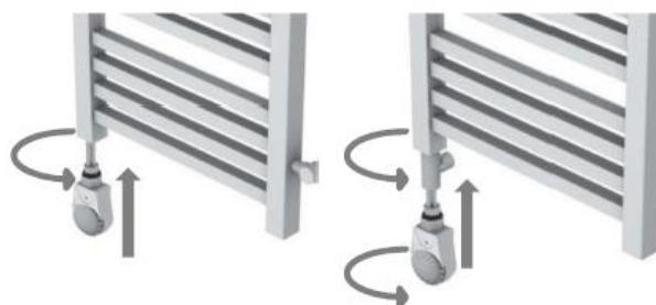
!!! Tilos a fűtőpatron a termosztát részének elforgatásával rögzíteni !!!
