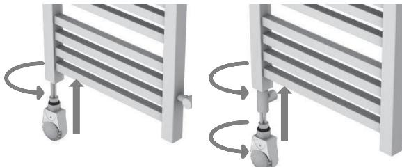
**!!! Es ist verboten, der Heizstab durch Drehen des Teils mit dem Thermostat zu befestigen!!!**
