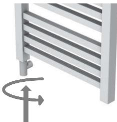
3) Nainstalujte topnou tyč ve vertikálním směru, topná spirála musí směřovat kolmo vzhůru. Topná tyč by měla být opatrně upevněna pomocí klíče 27 do otopného tělesa nebo T-kusu.
