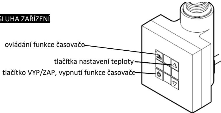
Topná tyč ohřívá otopné těleso a zároveň kontroluje teplotu vnitřní kapaliny. Vnitřní čidlo teploty chrání před opařením omezováním teploty otopného tělesa do 60 °C. Dodatečná tepelná pojistka reaguje na překročení teploty kapaliny 82 °C (při této teplotě dojde k poškození topné tyče).
