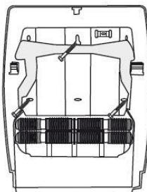
I Fissare alla parete il **Kompatto** con le viti in dotazione, usando gli appositi fori.
